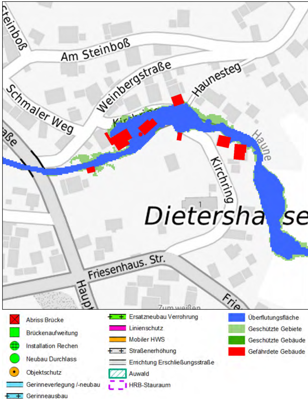
Abbildung 11-29: Überflutungsfläche HQ100 für Grundvariante 1 in Dietershausen
