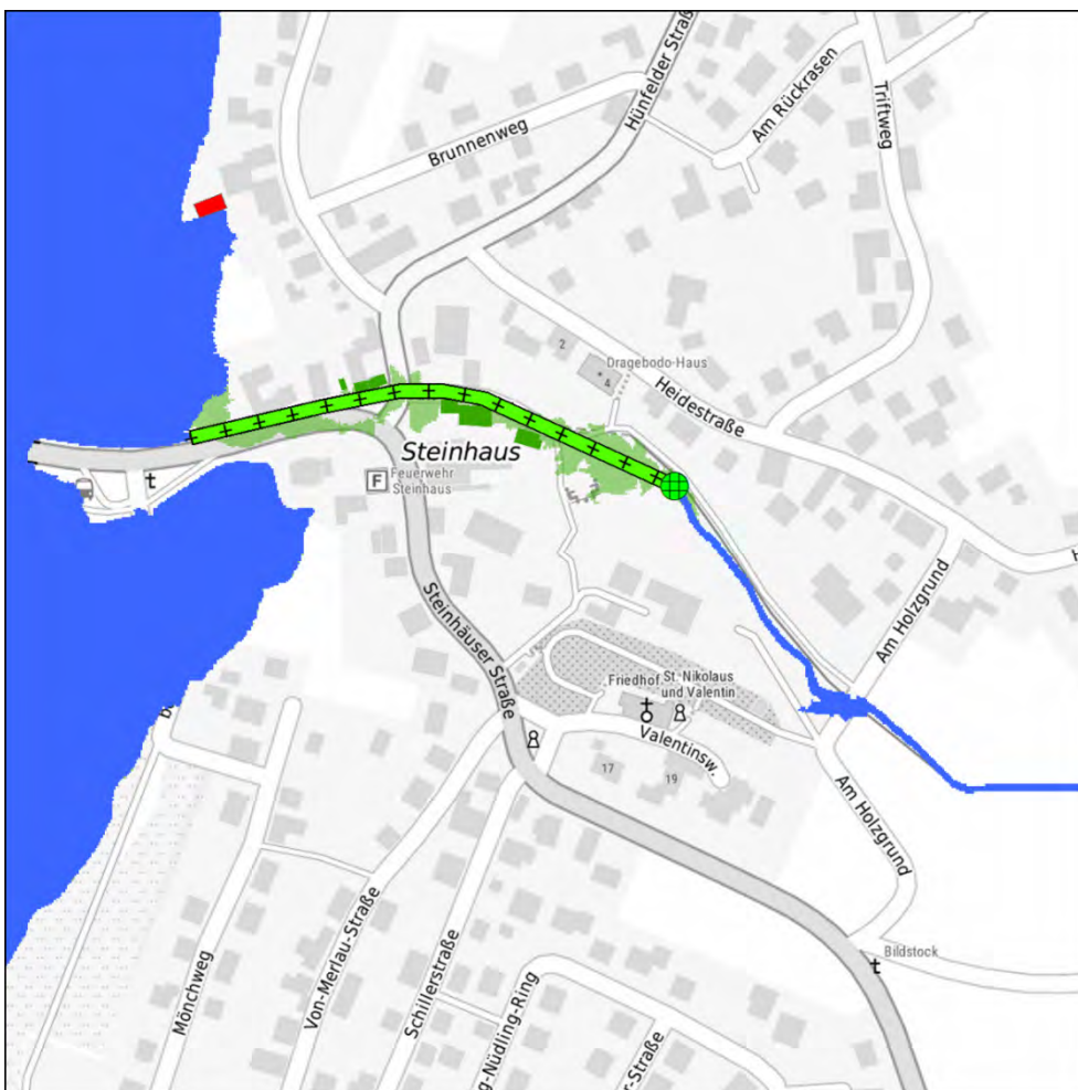
Abbildung 11-3: Überflutungsfläche HQ100 für Grundvariante 2 (Vorzugsvariante) in Steinhaus
