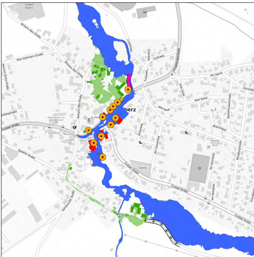
Abbildung 11-33: Überflutungsfläche HQ100 für Grundvariante 2 in Dipperz
