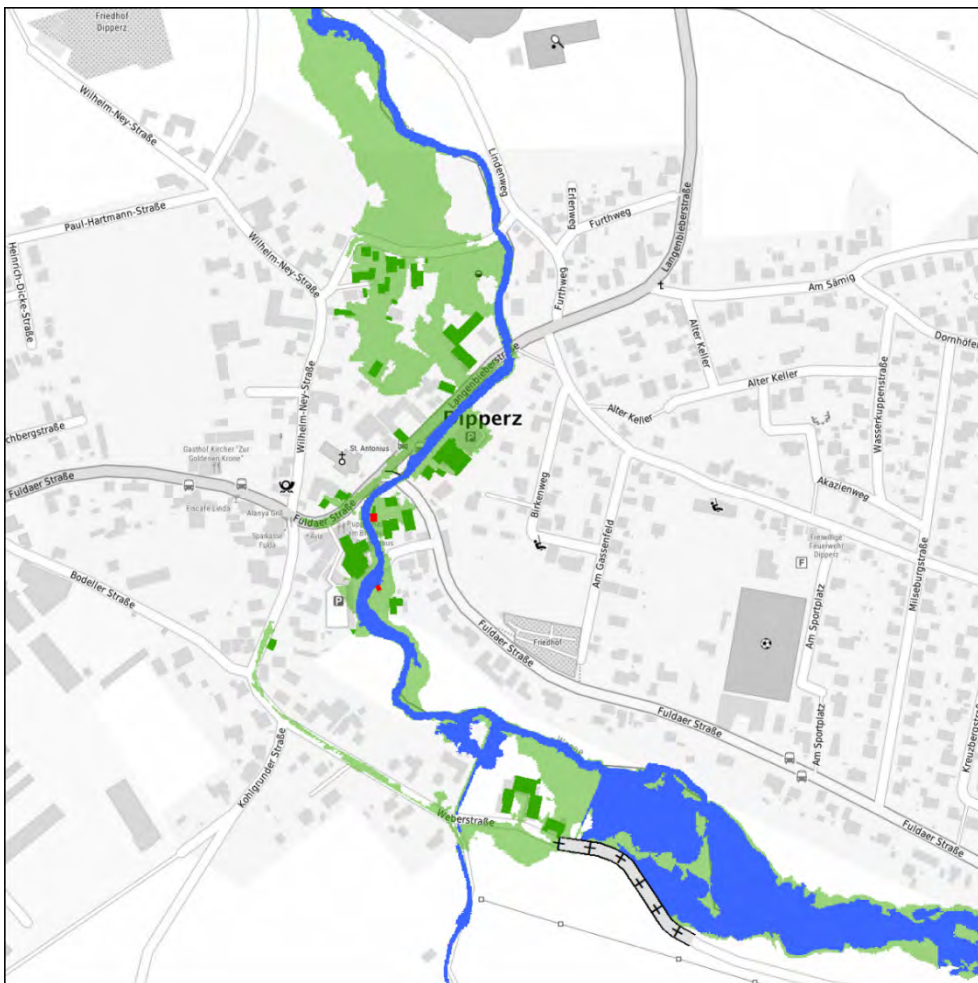
Abbildung 11-34: Überflutungsfläche HQ100 für Vorzugsvariante in Dipperz
