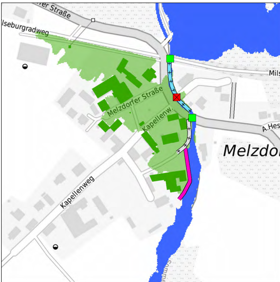
Abbildung 11-9: Überflutungsfläche HQ100 für Grundvariante 2 in Melzdorf
