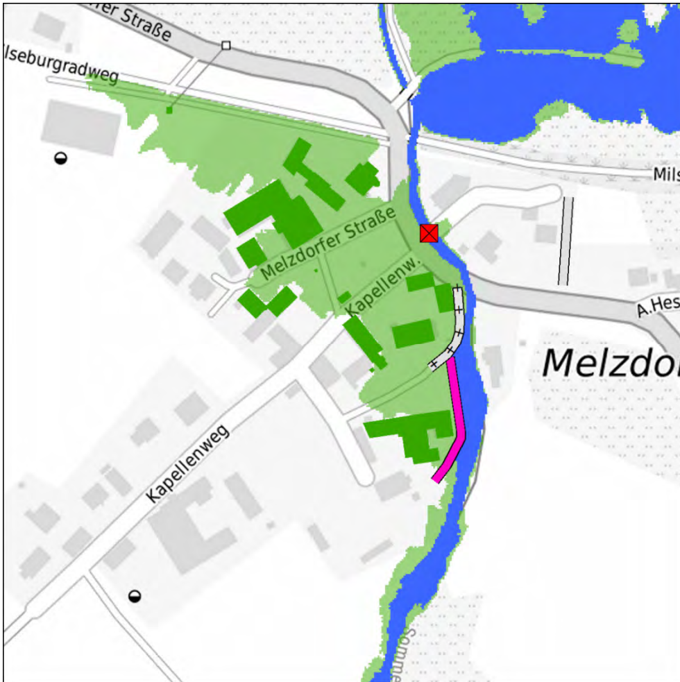
Abbildung 11-10: Überflutungsfläche HQ100 für die Vorzugsvariante in Melzdorf
